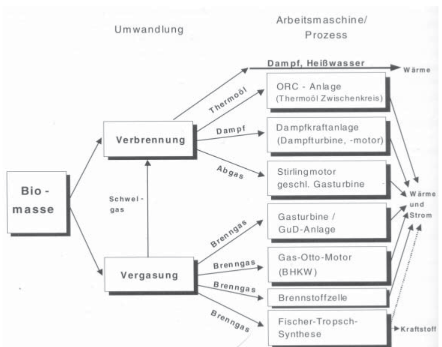
Abb. 28: Systematik der Umwandlungsschritte und Prozesse zur Erzeugung von Wärme und Strom aus fester Biomasse nach /Fichtner 2000/, / Energytech 2002 (Quelle: FNR/ Akt. 2000, S.94)
